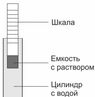
Рис.1.7 Ареометр для измерения плотности.
